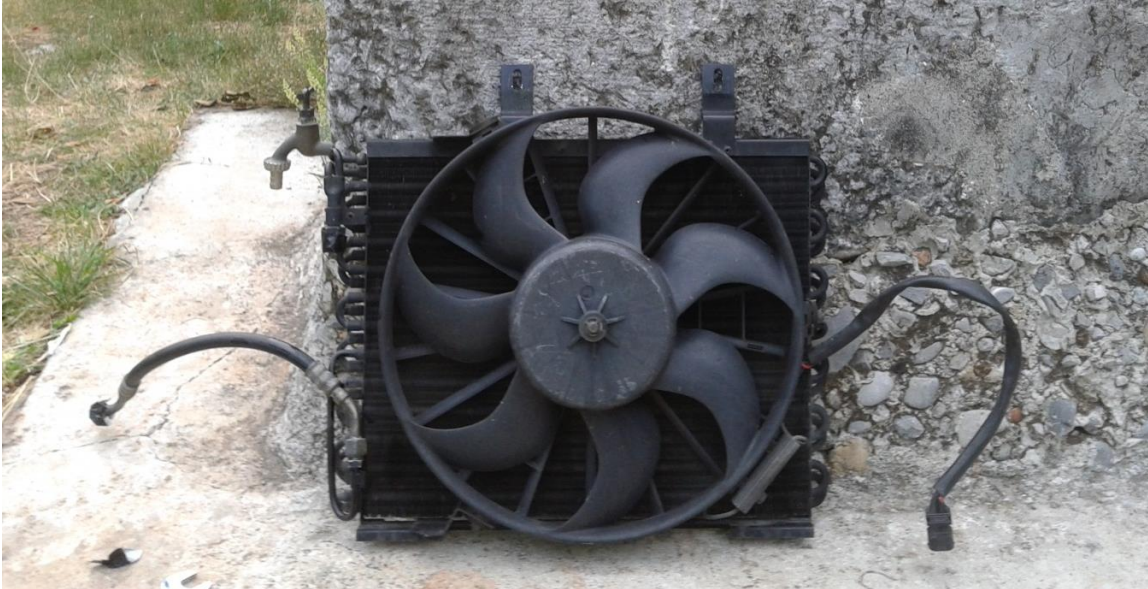
Slika: kondenzator pripravljen na vgradnjo skupaj z gibljivo cevjo.
