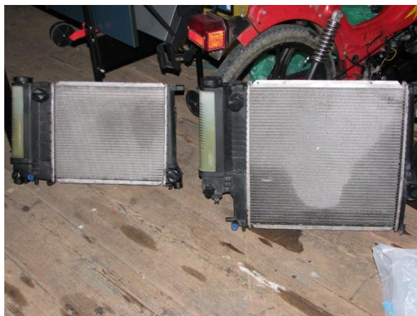
Slika: Dve skrajni velikosti hladilnikov v e30 (m40)-> na levi ozek in nizek hladilnik, na desni širok in visok
