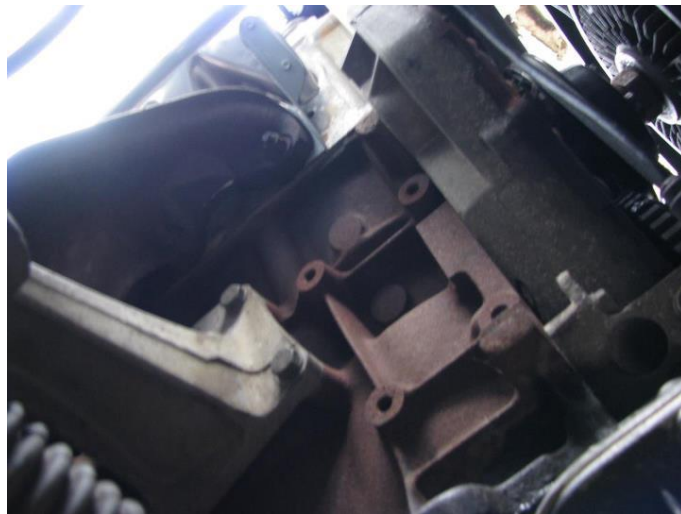
Slika: navojne izvrtine na bloku motorja
