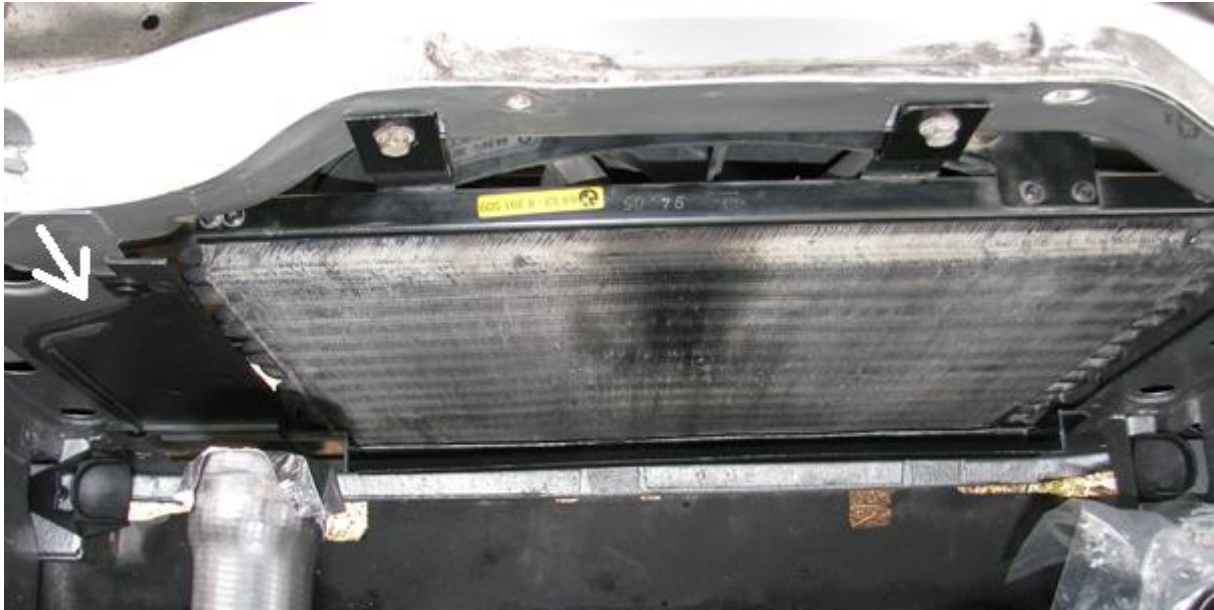
Slika: vgrajena zaščitna plastika (označena s puščico).
