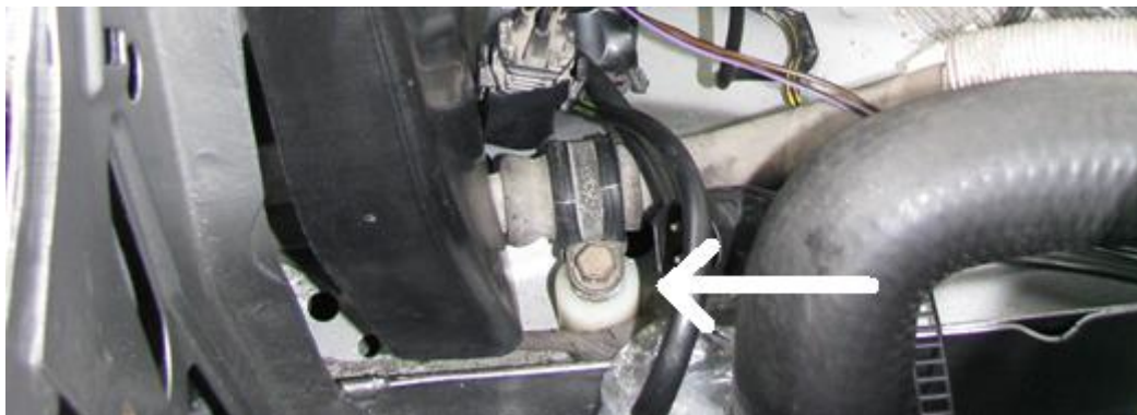
Slika: objemka okrog cevi s plastičnim distančnikom označenim s puščico.
