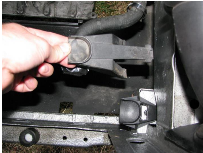
Slika: Oba možna nosilca hladilnika. Zgornji, večji je za ožji, spodnji vgrajen je za širši hladilnik.
