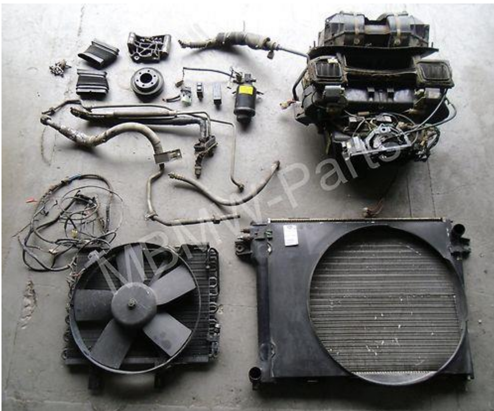
Slika: komponente klimatske naprave (na sliki manjka kompresor)
