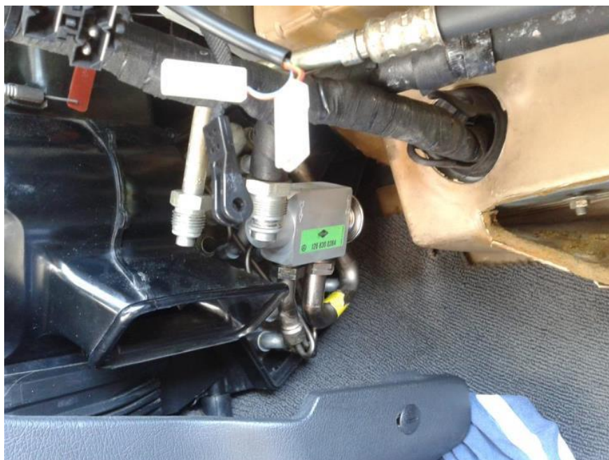
Slika: montaža novega ekspanzijskega ventila
