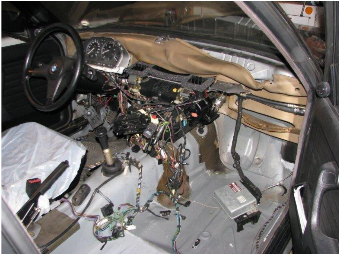
Slika: montirana pečka v notranjosti.
