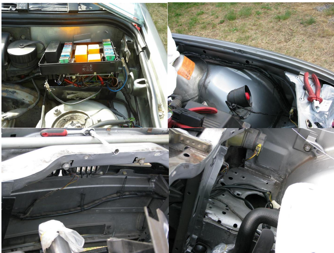
Slike: Potek kablov klima inštalacije po motornem prostoru.
