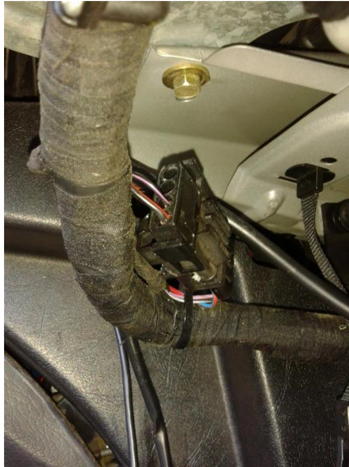
Slika: priklop konektorja pečke s konektorjem motorne inštalacije za regulacijo prostega teka
