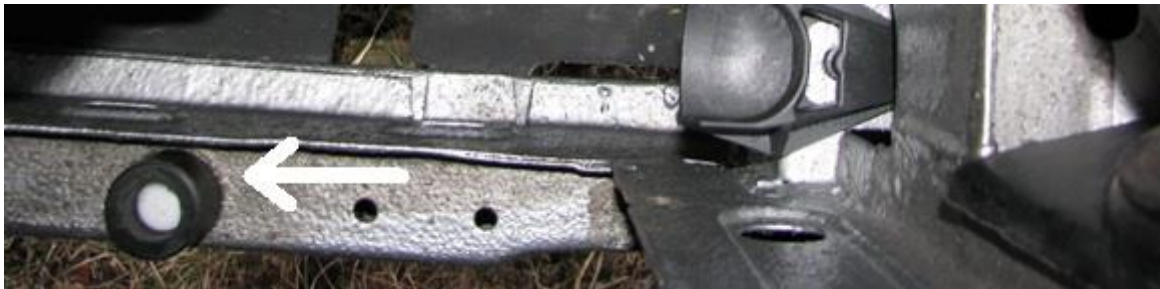
Slika: s puščico je označena amortizacijska guma kondenzatorja skupaj s čepkom.
